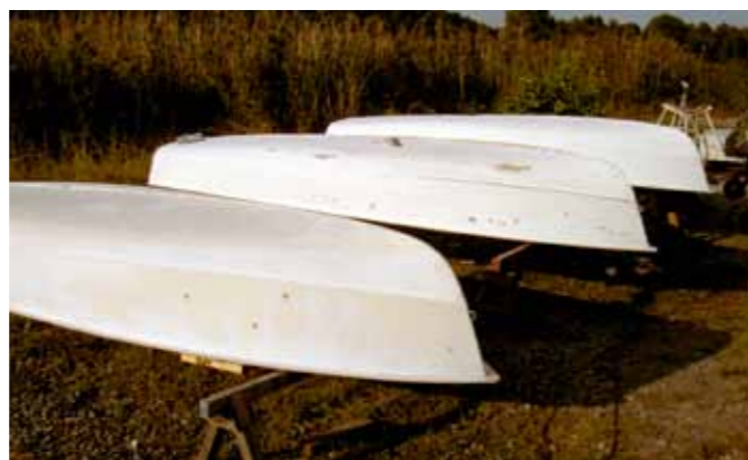
Så där, tre skrov rena från bottenfärg.
