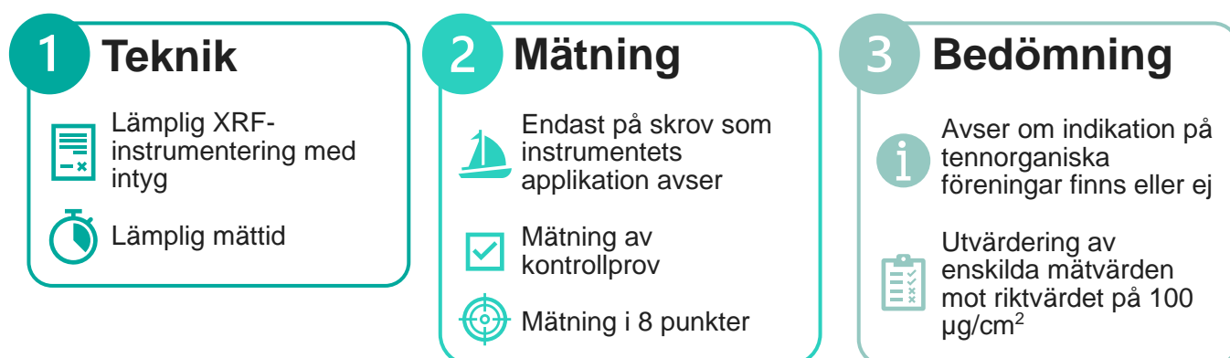
Figur 1 Schematisk översikt av förfarandet vid XRF-mätning och bedömning av tennhalter på fritidsbåtsskrov.
