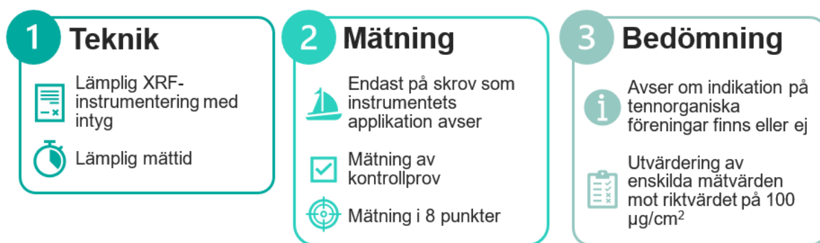
Figur 16. Schematisk översikt av förfarandet vid XRF-mätning och bedömning av tennhalter på fritidsbåtsskrov.
