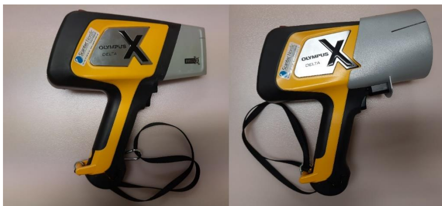
Figur 9. Chalmers Innov-X Delta-50 instrument, med (höger) och utan blyhölje (vänster).
