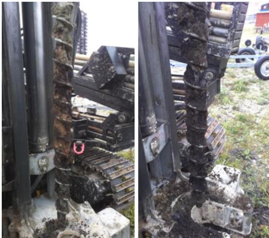
Figur 4. Fyllnadsmassor med slagg, KaBK 5. Slagg påträffas från 0–1,5 m u .m y.
