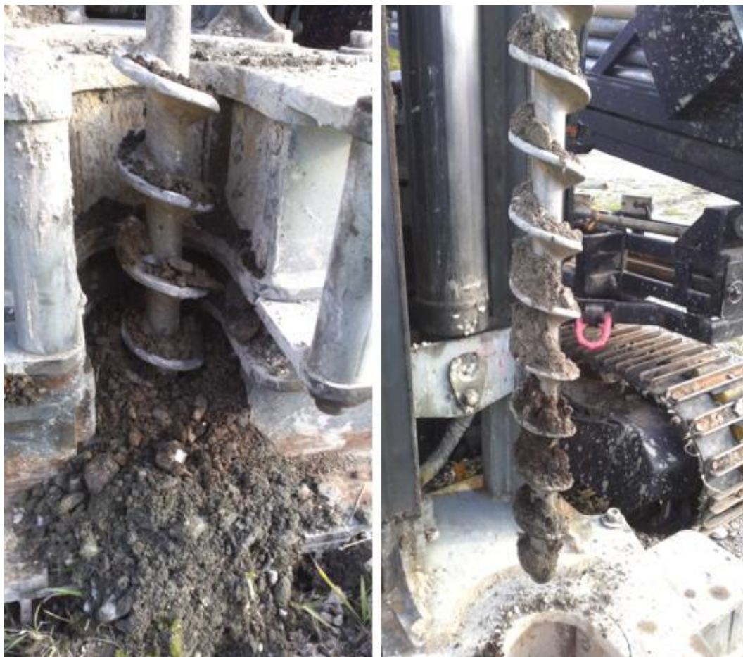
Figur 5. Fyllnadsmassor från KaBK 3 med inslag av stenig grusig sand och slagg i botten av skruv vid 1 mu m y.
